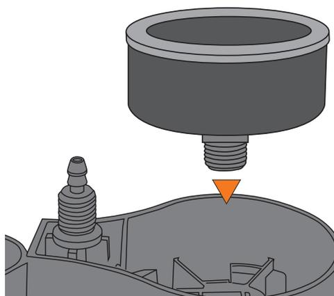
5. Manometer mit max. 2Nm anschrauben
