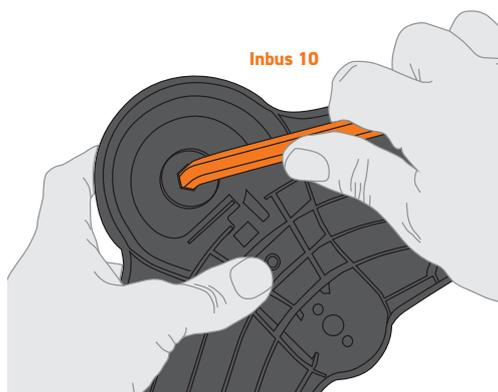
4. Drehen Sie den Manometerhalter um ca. 45° gegen den Uhrzeigersinn bis ein Widerstand zu spüren ist. Danach ziehen Sie den Manometerhalter heraus
