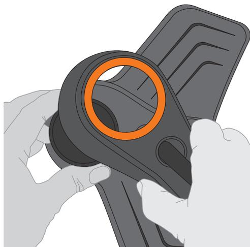
3. Manometer an der Unterseite mit Inbus (Größe 10) herausschrauben
