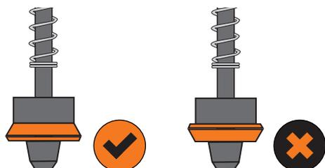
4. Gummistopfmanschette fetten, wieder einsetzen und verschrauben.
