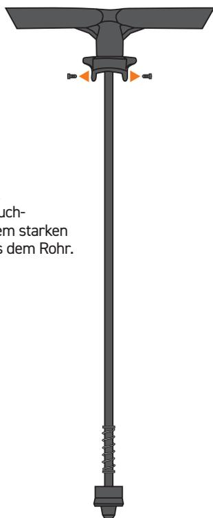
2. Entfernen Sie die alte Topfmanschette. Nutzen Sie hierfür ggf. Werkzeug (z.B. Schraubendreher).
