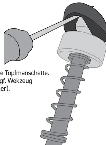
3. Stülpen Sie die neue Topfmanschette über die Kolbenstange, bis die Manschette in der dafür vorgesehenen Fuge sitzt.
