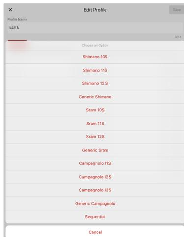
Wähle einfach in der App das bevorzugte Schaltsystem aus, um die Schaltgruppen der führenden Hersteller mit den **Hebeln und Tasten am Lenker zu imitieren**, genau wie bei deinem Outdoor-Fahrrad.
